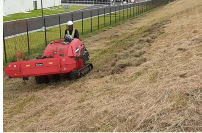
堤防の除草作業
